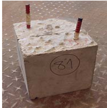
Figura 1. Fotografía de Probeta sometida a carbonatación y penetración de cloruros.
