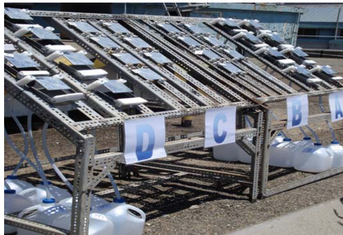
Figura 1. Distribución de las muestras de acero galvanizado en el bastidor de la estación atmosférica.
